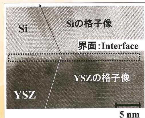
図2 結晶化誘発YSZ層上に430℃で堆積した多結晶Si薄膜の断面透過電子顕微鏡(断面TEM)像。SiがYSZの結晶情報に刺激されて界面から結晶成長している。(Appl. Phys. Express, Vol. 2, pp. 04120 1-3, 2009.)
