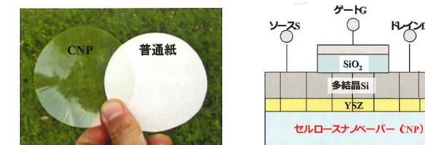
図5 (a)セルロースナノペーパー(CNP)と普通紙との比較(阪大 能木提供、応物物理 Vol.84, No.6,p.536, 2015年) CNPはnmオーダー幅のセルロース繊維で構成されているため、光の乱反射が少なく、透明になる。(b) CNPを基板としたTFTの模式図。本研究は、大阪大学 能木雅也 教授との共同研究である。
